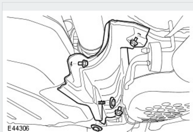
APOIO E FIXAÇÃO DO TANQUE — 310-01B
